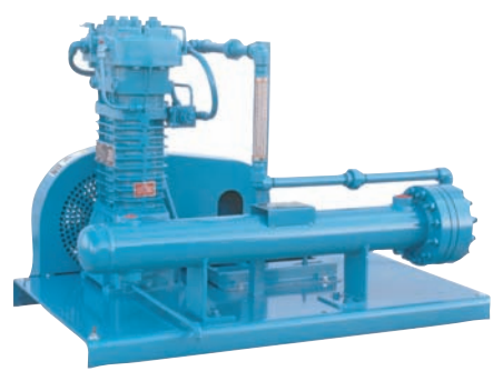
Compresor HDL372 de dos etapas refrigerado por agua con enfriador posterior para servicio de recuperación de helio.
