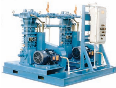
Compresores Duplex HD613 de dos etapas y sello triple con panel de control para operación de aumento de presión de gas natural.
