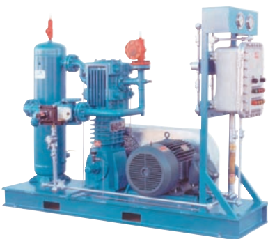
Compresor HD942 con panel de control a prueba de explosiones y válvula de control de flujo de cuatro vías accionada eléctricamente para transferencia de gas licuado de petróleo (LPG).
